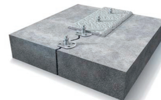
Aplicação de bicos de adesão para reparo estrutural
