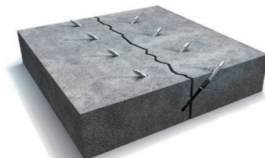
Aplicação de bicos de perfuração em trincas e fissuras passantes
